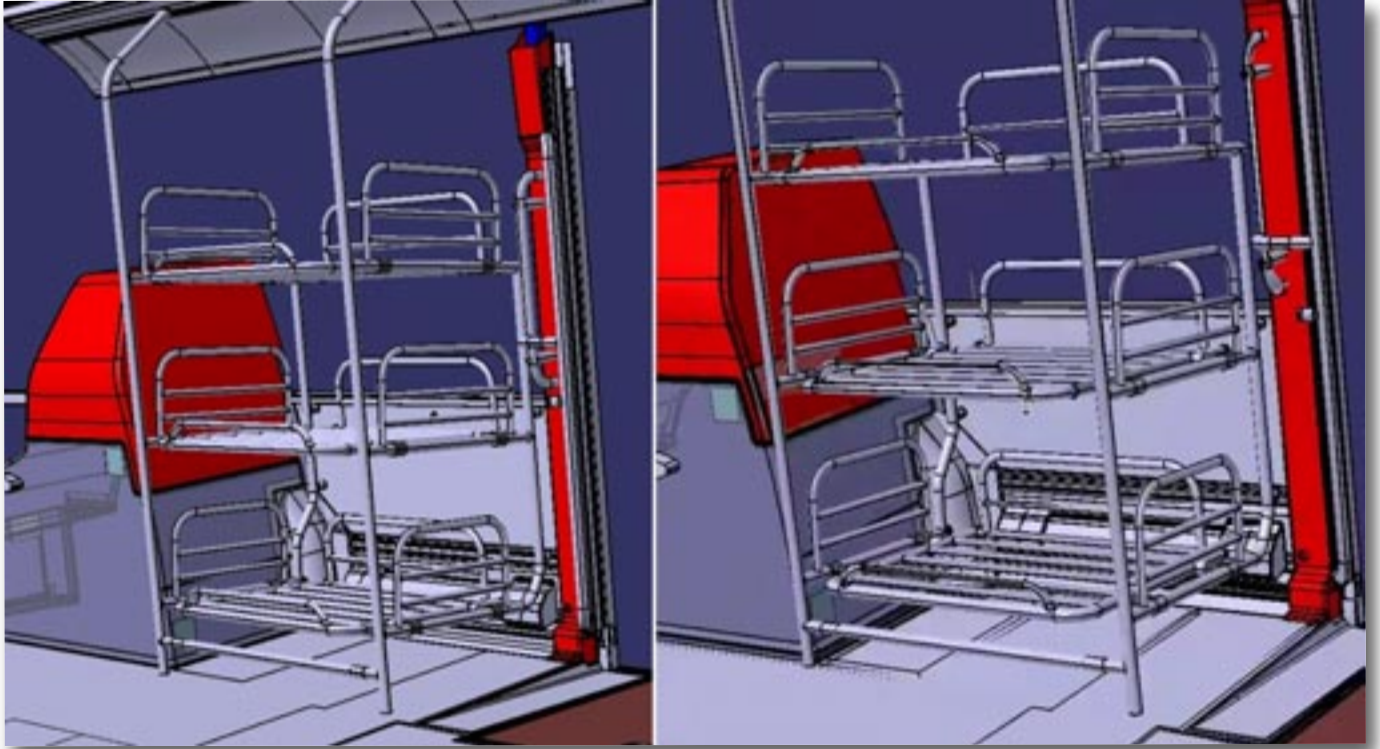
En 3D-tegning af bagageracket, som man kan ane på billederne på næste side.
