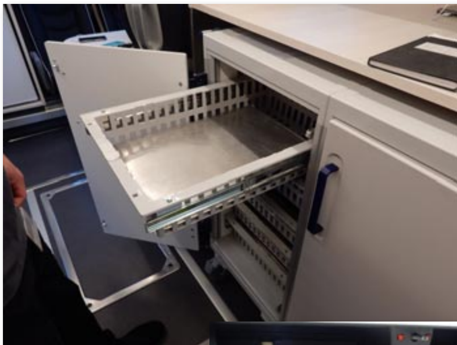
Til venstre: Blodskuffe med køleplade i bunden - disse tages ud og nedkøles hver aften ved ankomst til bussens standplads.
