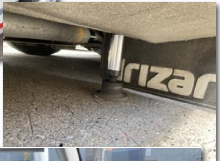
Betjeningspanelet for de fire stabilisatorben og stabilisatorbenet i funktion.
