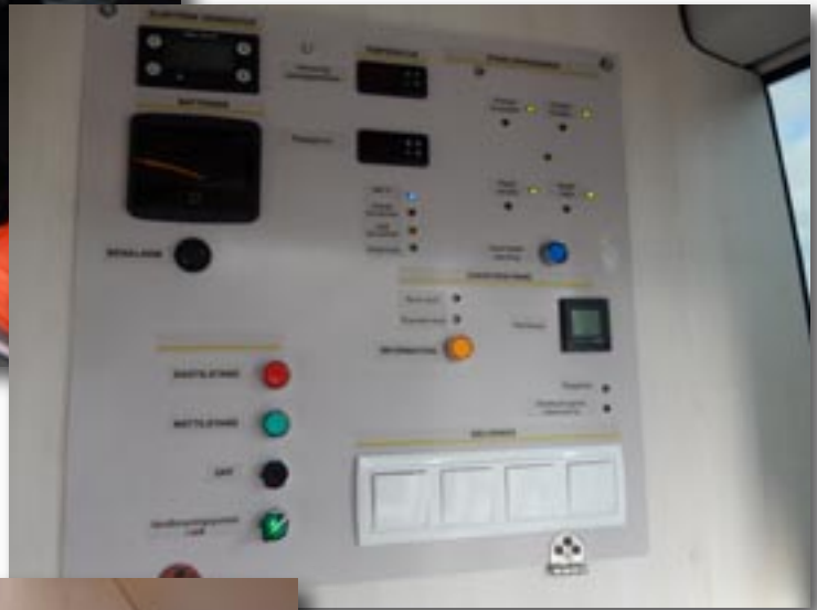
Ovenfor. Betjening og overvågningspanelet til bussens vand og klimaanlæg, samt generator. Læg mærke til, at den er på 380 V. Panelet er placeret bag førersædet.
