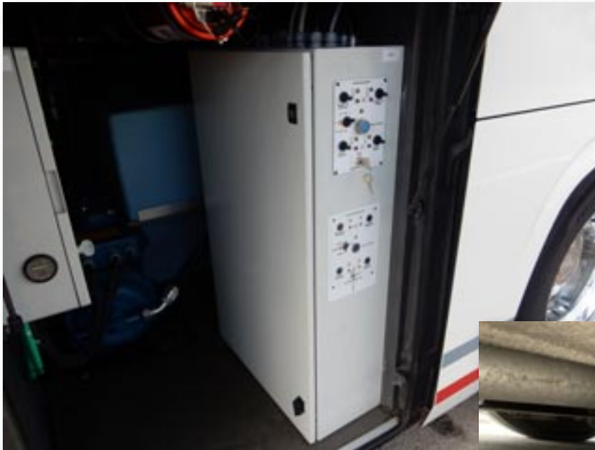
Betjeningspanelet for de fire stabilisatorben og stabilisatorbenet i funktion.
