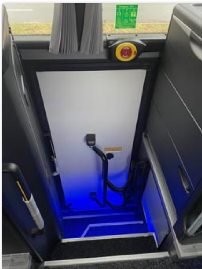
Ovenfor: Udgangen er også adgangen til toilettet, der er placeret til venstre og til chaufførens sovekabine, hvor indgangen er placeret til højre.
