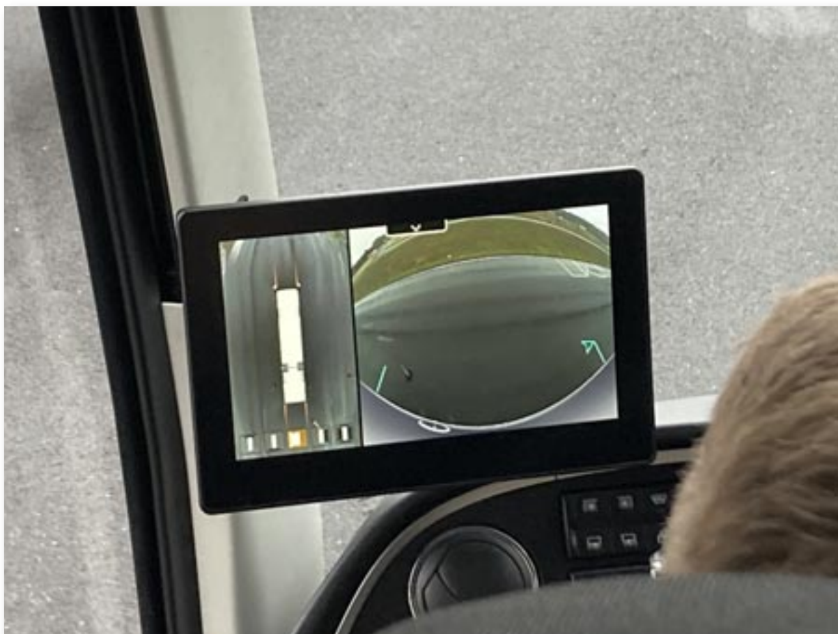
Her er skærmen under kørsel. Bussens længde er angivet med de to grønne pinde - eksempelvis under en overhaling.
