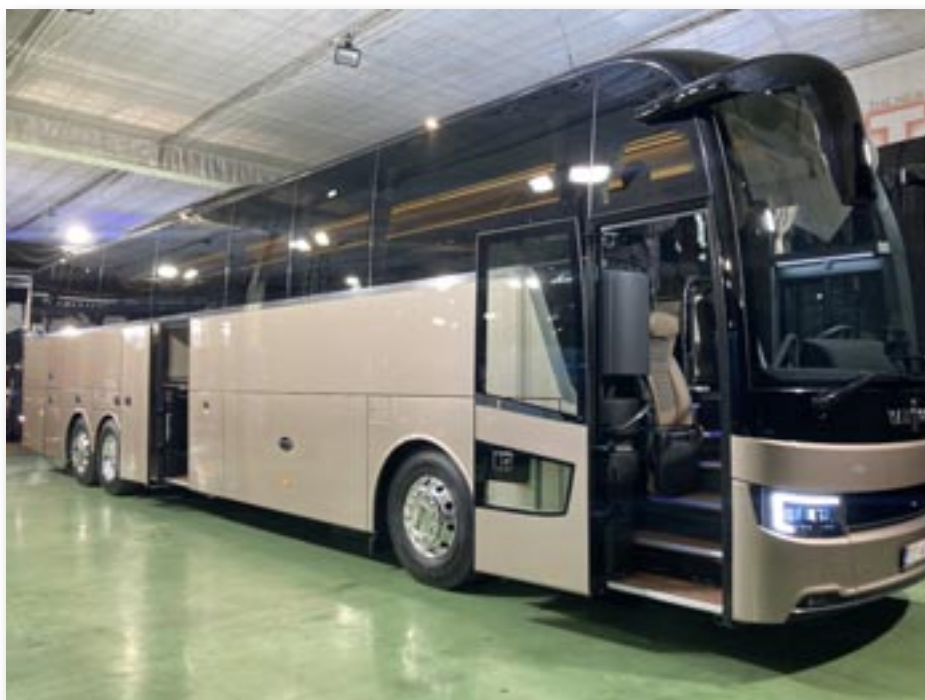
Van Hool Acron med kørestolslift og indvendigt gulv uden podestre.
