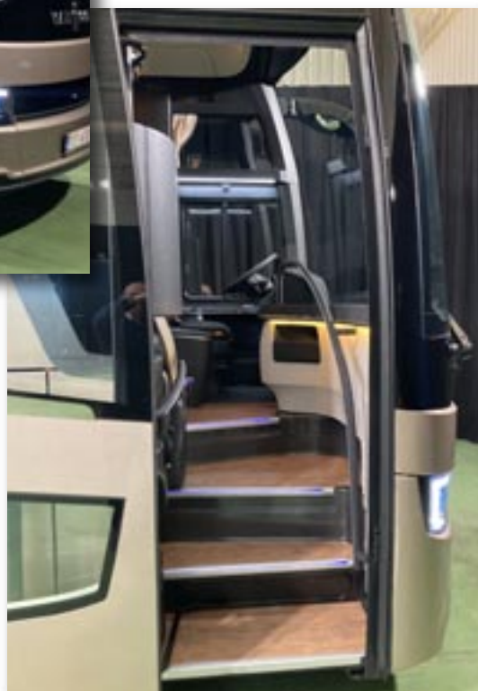
Van Hool Acron med kørestolslift og indvendigt gulv uden podestre.
