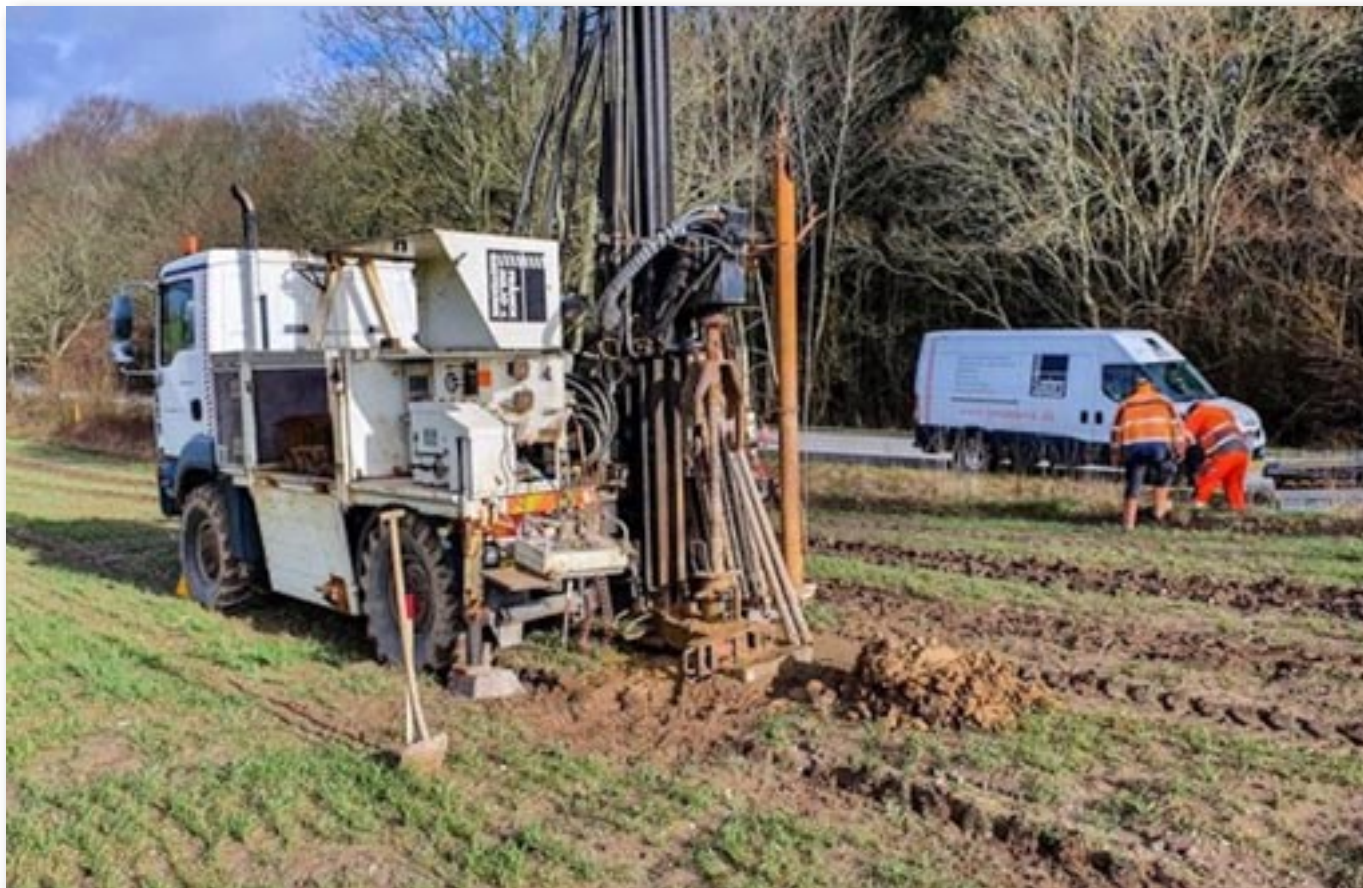
Geoteknikere borer huller langs den kommende linjeføring og henter jordprøver op til analyse. (Foto: IN-SITU Consult)
