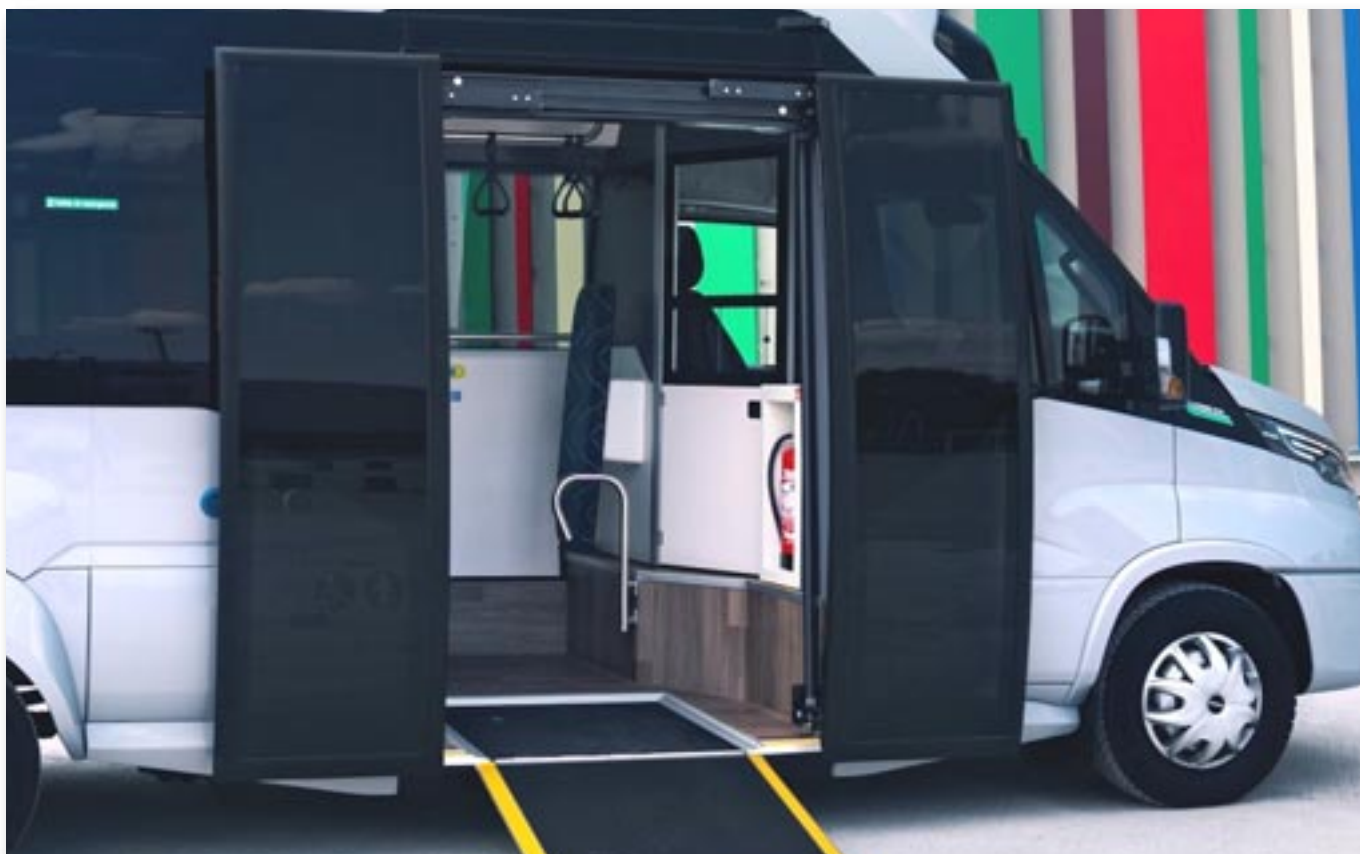
Daily'en havde rampe til kørestolsbrugere.
