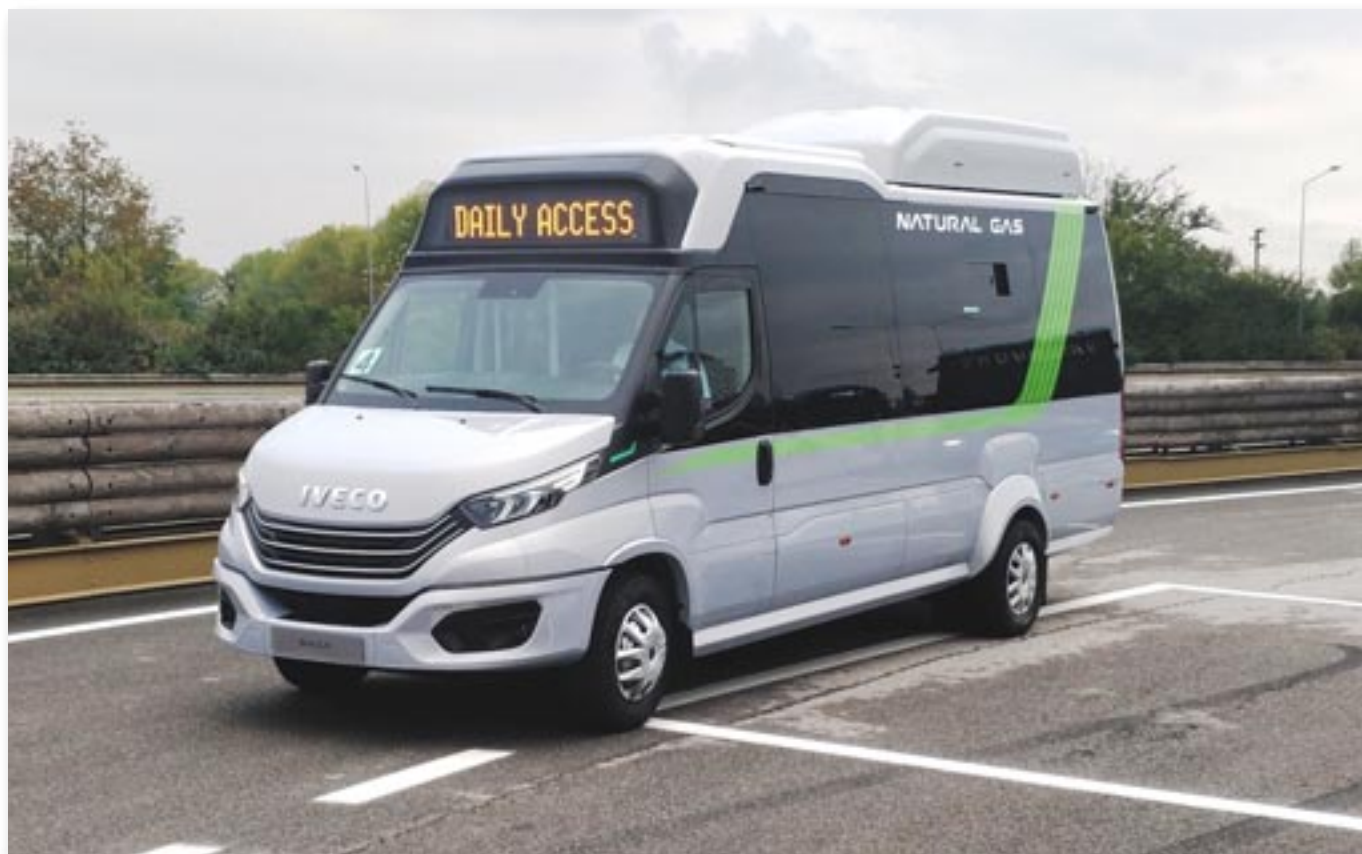
Daily med gasmotor har gastankene på taget.
