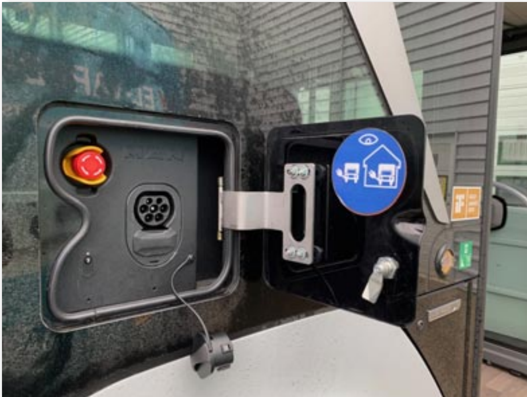
Tankdækslet dækker over en kabeltilslutning - og et nød-stop, hvis det skulle blive for spændende.
