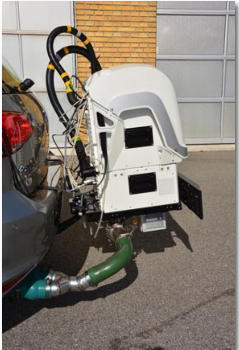
PEMS (Particle Emission Measurement System) tilsluttet udstødning for at måle under virkelig kørsel. (Foto: Teknologisk Institut)
