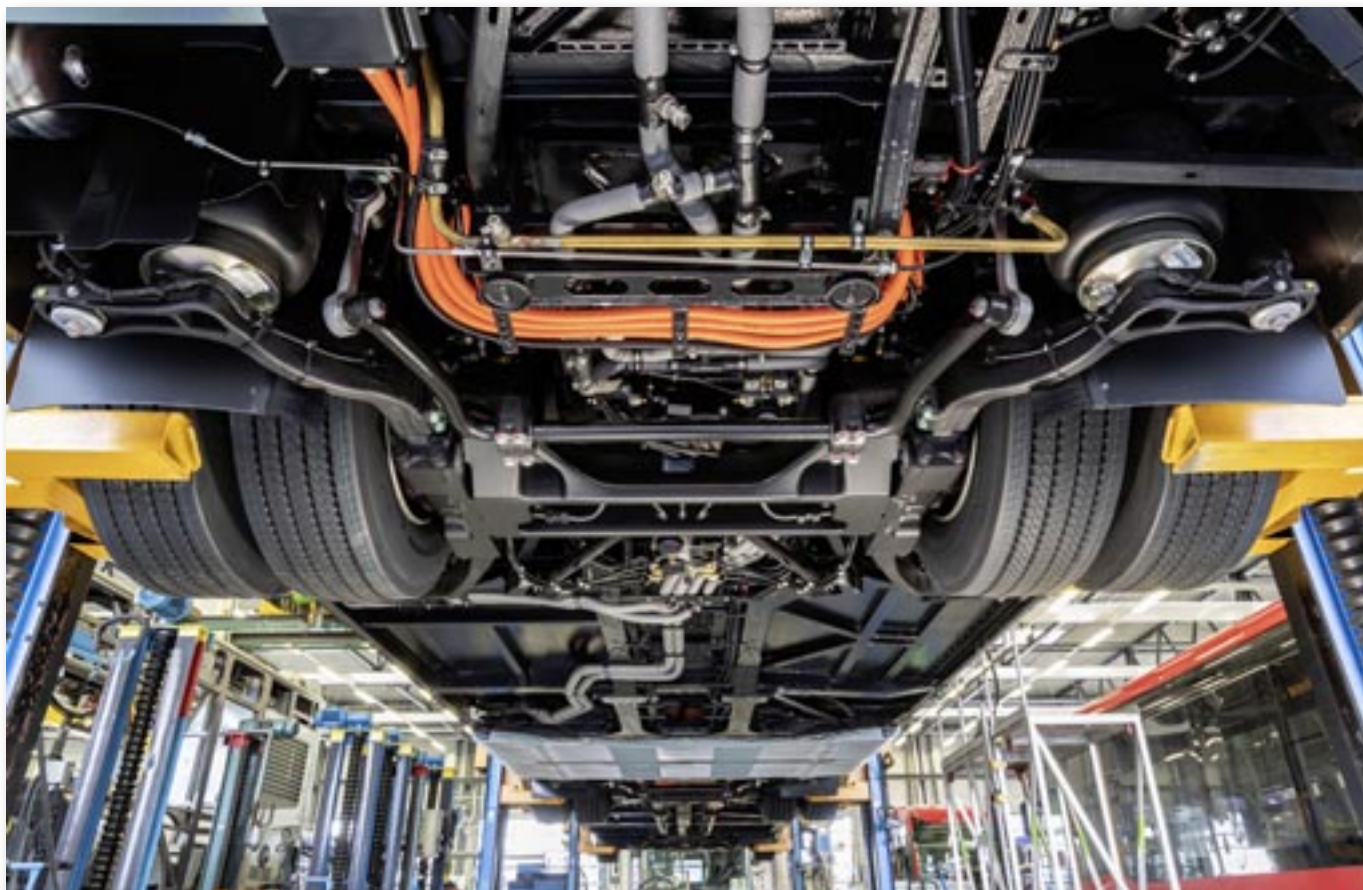
Sådan er det ud under en elektrisk bus fra Mercedes-Benz.
