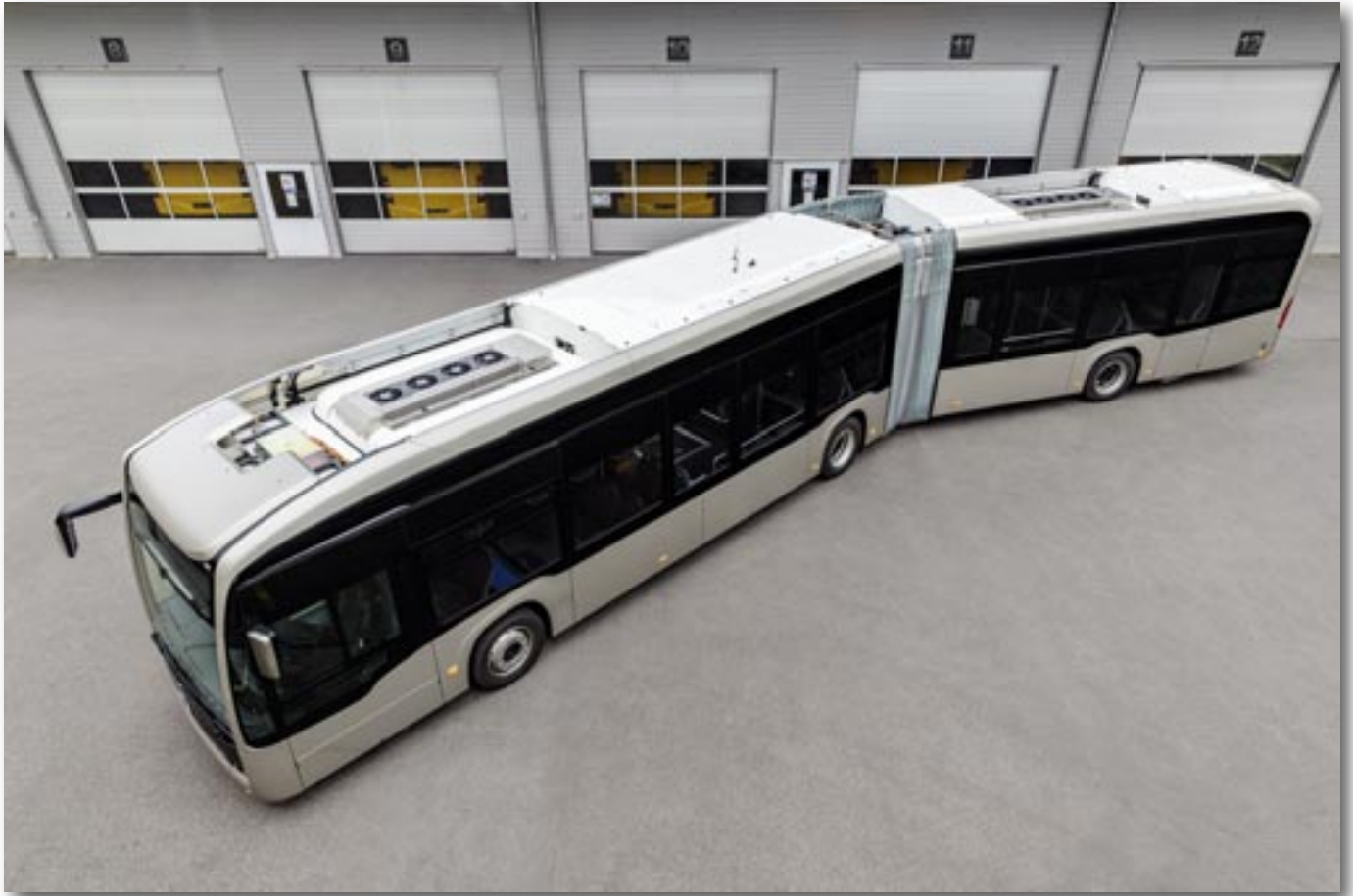
Batterierne på eCitaro som ledbus er placeret på taget på "forvognen" beskyttet af et stort "dæksel"
