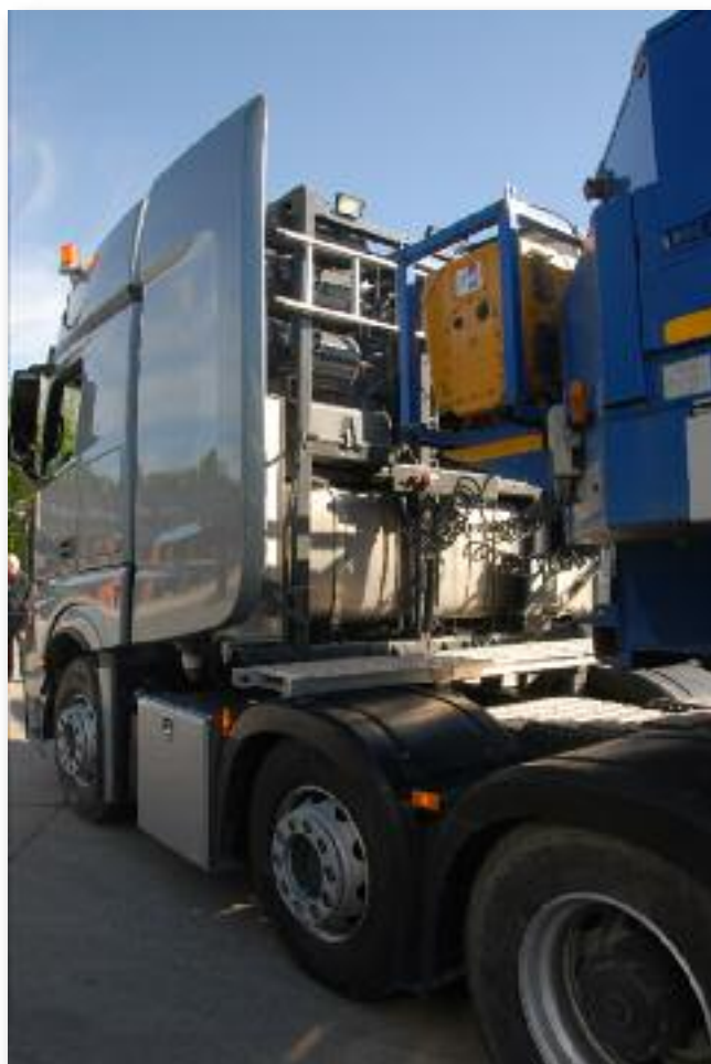
Kølesystemet til motor og hydraulik på både trækker og blokvogn er placeret bag på førerhuset mellem sidespoilerne. Her er tanken til hydraulikken også placeret.
