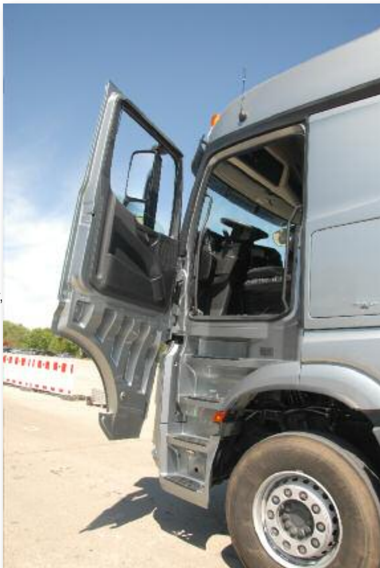
Der er fem trin op til førerpladsen i Actros og Arocs SLT Sværgods-trækkerne. Fra førerpladsen er der et godt udsyn frem, til siderne og bagud via spejlene. Førerpladsen er velindrettet med godt placerede betjeningsknapper.
